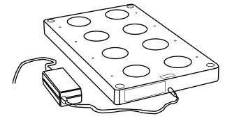
Зарядная станция MOM 8 multi для одновременной зарядки до 8 светильников. Могут собирать в стойки до 10 уровней. Зарядная станция MOM 8 MULTI использует адаптер Вход 100-240B AC~50/60 Гц - Выход DC 9B 5A
